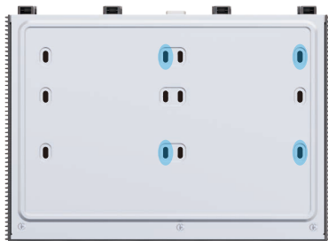
Para instalação do disco rígido de 2,5 polegadas
